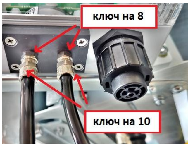
Рисунок А.18 - Отсоединение воздушных магистралей от газоанализатора
